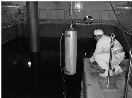
写真2 中性子センサと線センサを収納したステンレス製円筒(写真中央)
